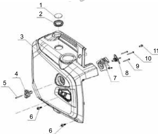
Ensamble cubierta izquierda
